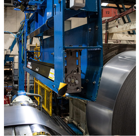
그림 2 조질압연기에 설치된 SmartView® 시스템
