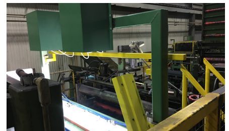
캐나다 온타리오주 스톤 크릭에 있는 Samuel Nelson Steel에 SmartView® 표면 검사 시스템 설치.
