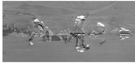
다양한 모양과 크기의 결치는 재료의 결합 영역을 강조 표시하는 적층 시각화, 압연 재료의 표면에 불규칙하게 분포되고 종종 기본 표면에 부분적으로만 결합됩니다.
