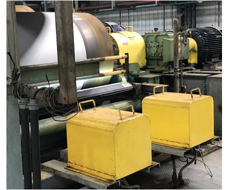
그림2 SmartView 시스템은 스트립 파손 빈도를 줄이는데 도움이 되었습니다.
